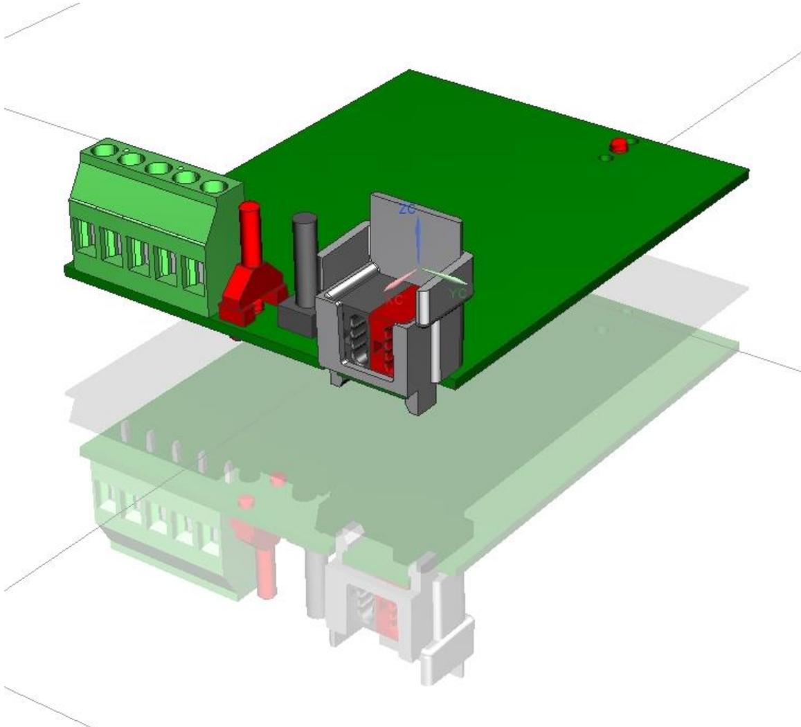
Um den KNX/EIB Netzanschluss zu realisieren wurde eine spezielle Lösung mit einem Zusatzteil geschaffen.
